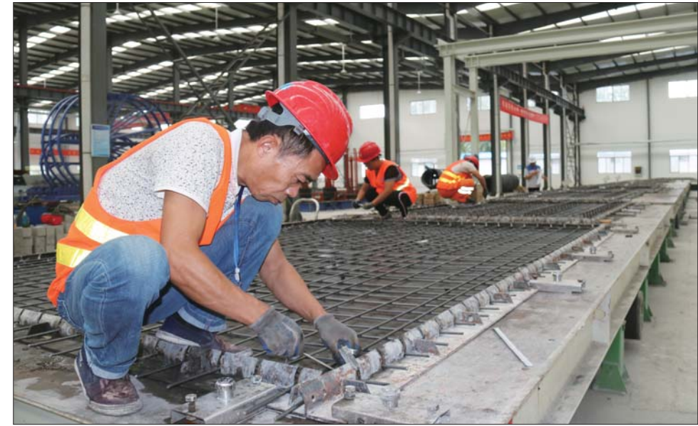
工人正在车间内进行绑扎钢筋作业。
