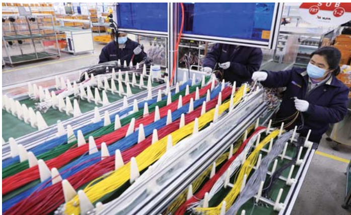
在乐陵承佑电器装配有限公司线束生产车间,工人正加紧生产直供北京现代汽车的汽车线束订单
