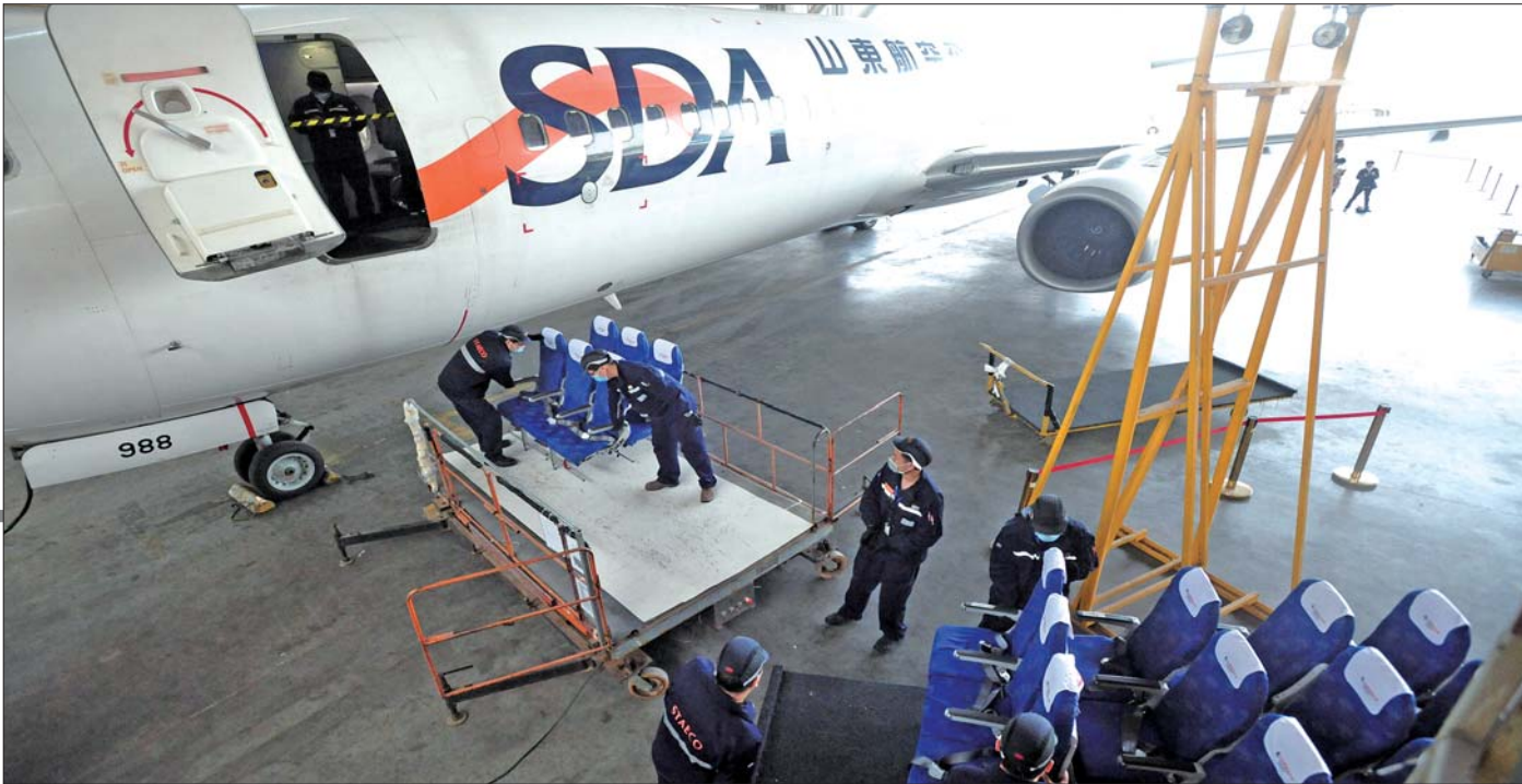
山航一架波音737-800客机拆下座椅,改装成一架全货机。本版照片 齐鲁晚报·齐鲁壹点记者 张中 摄
