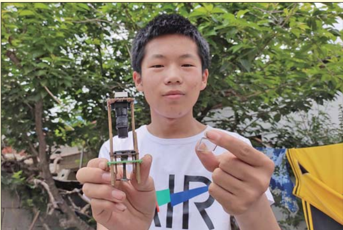
用废旧监控摄像头和凹凸镜片,宋端安制作了一个电子显微镜。
