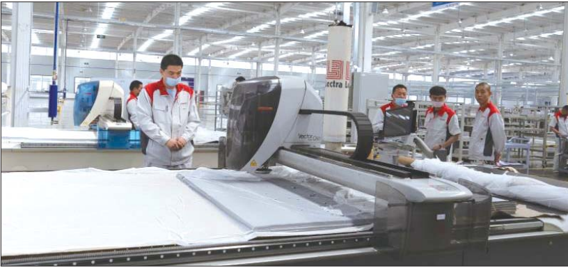
诺博汽车零部件(宁阳)有限公司,智能裁床对皮质材料进行裁剪定性。
