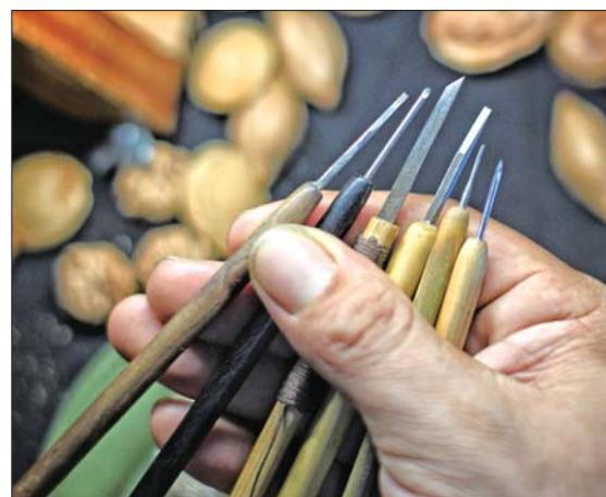
▲废锯条、小钻头、缝纫机钢针，这些物品经过张继新的打磨，变成了最顺手的核雕刻刀。
