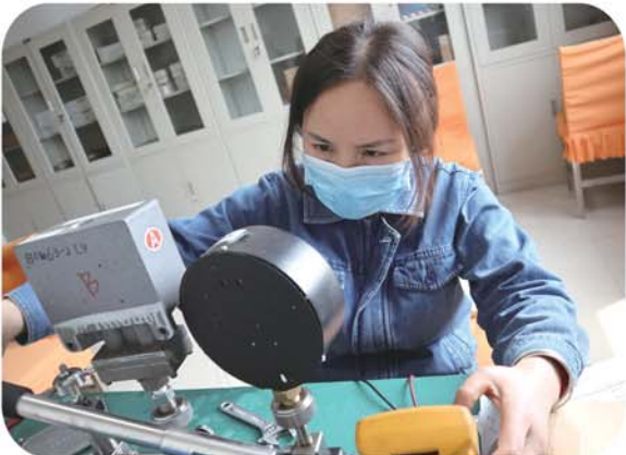
检修部热工班唐婧校验压力开关。
