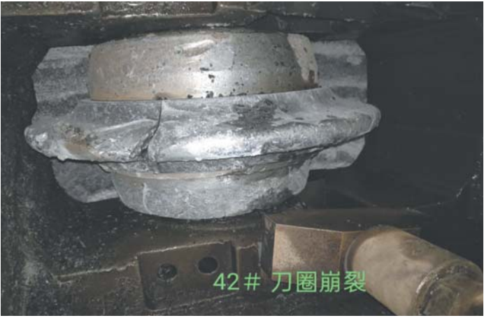
孤石群、空洞地层刀具损坏严重，刀圈崩裂。通讯员 赵山杰摄
